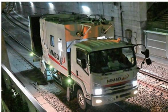
写真-1 計測走行中のMMSD計測車両
